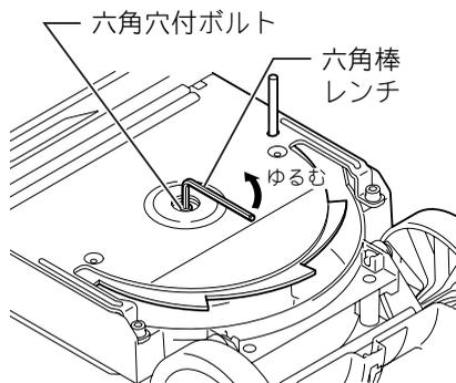
5. 底板固定用の2本の六角穴付ボルトをゆるめ、底板、六角穴付ボルト、アウターフランジの順で取りはずし、刃物を交換します。
