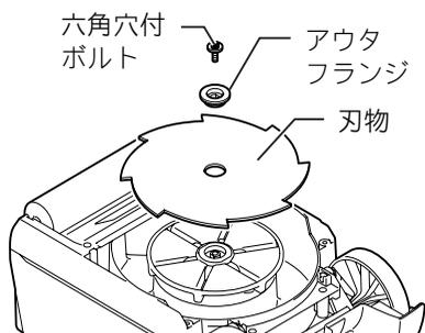
6. 刃物の取り付けは、底板の矢印と刃物に表示の矢印の向きを合わせてください。
