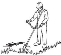
2. 飛散防護カバーは必ず指定の位置に取り付けて使用してください。
