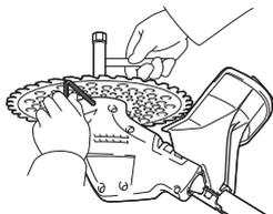
3. 刈刃を取り付ける場合は、刃受金具の凸部と刈刃の取り付け穴を確実にはめてください。
