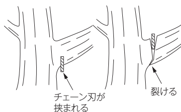
下側からの切断 上側からの切断
