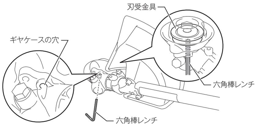
4. 六角ナット（左ネジ）を付属のボックスレンチで右へ回して、締付ナット、カップ、刃押金具をはずします。
