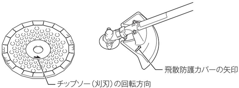
6. 刃受金具の凸部とチップソー（刈刃）の取付穴を合わせて、チップソー（刈刃）→刃押金具→カップ→締付ナットの順に取り付け、締付ナットを付属のボックスレンチで左に回してしっかり締め付けます。
