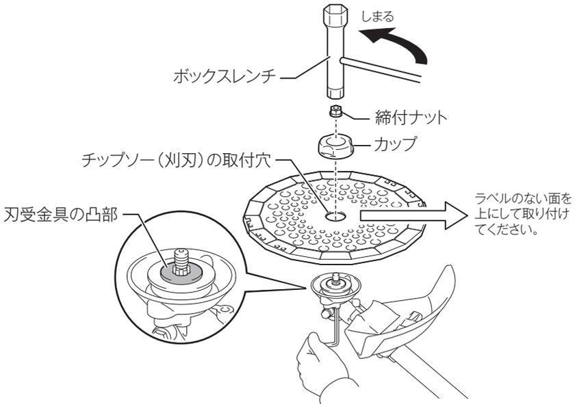
7. 六角棒レンチをはずし、チップソー（刈刃）を手で軽く回してチップソー（刈刃）の取付穴が刃受金具の凸部からずれていないことを確認します。ずれている場合は、もう一度チップソー（刈刃）を取り付け直してください。
