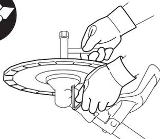
3. 刈刃を取り付ける場合は、刃受金具の凸部と刈刃の取り付け穴を確実にはめてください。
