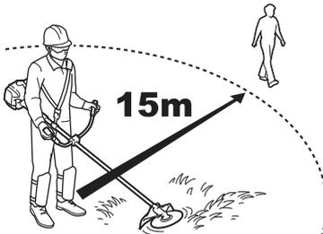
2. 本機を使用している人に近づくときは、使用者から 15m 以上離れた位置で合図し、エンジンの停止と刈刃の回転の停止を確認してから近づいてください。
