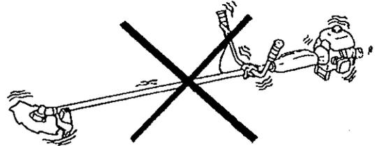
9. 刈払機から離れる時または、休憩時にはエンジンを停止し刈刃の回転が停止したことを確認してから刈刃に刃物カバーを取り付けてください。
