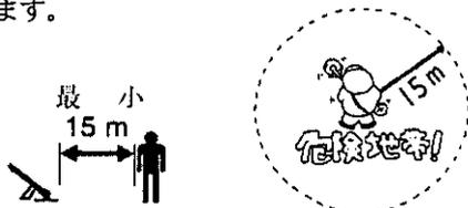
2. 刈払機を使用している人に近づくときは、使用者から15m以上離れた位置で合図し、エンジンの停止と刈刃の回転の停止を確認してから近づいてください。
