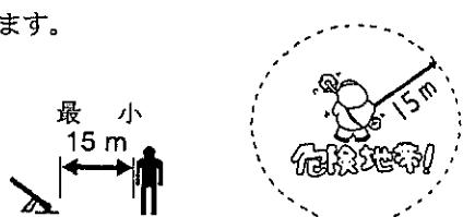
2. 刈払機を使用している人に近づくときは、使用者から15m以上離れた位置で合図し、エンジンの停止と刈刃の回転の停止を確認してから近づいてください。
