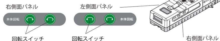
⚠ 注意 追尾モード時に回転スイッチを操作すると、墨出し器の輝度は「通常モード」に切替わります。
