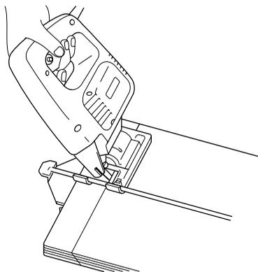
・ ベースを傾斜させるには、ベース下部に付いている締め付けボルトを六角棒レンチでゆるめて、ベースを動かして、ベースの半円部に付いている横溝を締め付けボルトの位置に合わせてください。
