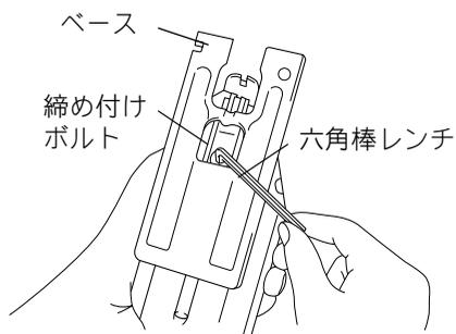
・ モーターハウジングの A 部 (エッジ部) をベースの半円部の目盛りに合わせ締め付けボルトを六角棒レンチでしっかり締め付けてベースを固定してください。
