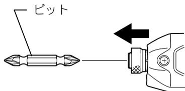
・ ビットピースを使用する場合は、スリーブを矢印方向に引きビットピース・ビットの順に差し込み、スリーブを離してください。
