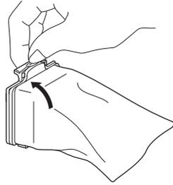
4. ゴミストッパーの矢印に合わせてゴミストッパーとダストバッグをいっしょに本製品の溝に奥までしっかり差し込みます。
