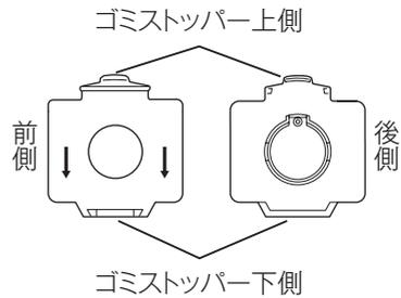
2. 図のようにゴミストッパー下側の溝に紙パック凸部を差し込みます。
