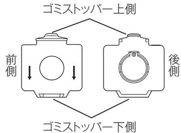
1. 図のようにゴミストッパー下側の溝にダストバッグ凸部を差し込みます。
