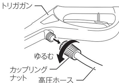
7. カップリングナットを左に回してゆるめ、高圧ホースをはずします。
