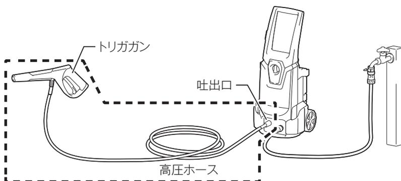
1. 高圧ホースを本製品の吐出口の奥まで差し込み、カップリングナットを右に回して締め付けます。
