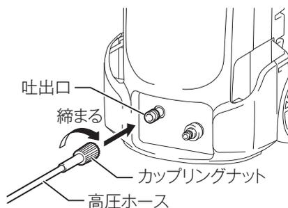
2. 高圧ホースをトリガガンの取り付け口の奥まで差し込み、カップリングナットを右に回して締め付けます。
