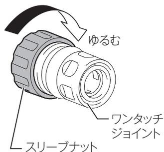
2. 耐压ホースにスリーブナット、ワンタッチジョイントの順に取り付け、スリーブナットを矢印方向に回して締め付けます。
