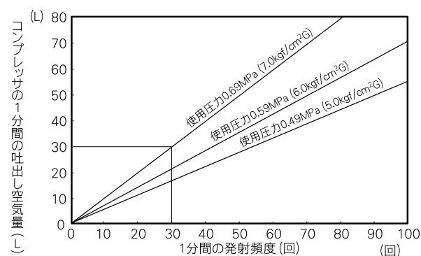
ば、使用圧力が 0.69MPa(7.0kgf/cm<sup>2</sup>) で発射頻度が 1 分間に約 30 回ですと、吐出し空気量 30L / 分以上のコンプレッサが必要です。
